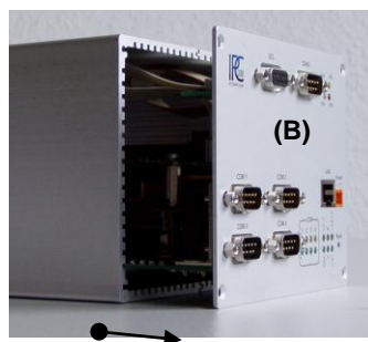
Abb. 2.5.2 Frontplatte (B) in Pfeilrichtung herausziehen.
