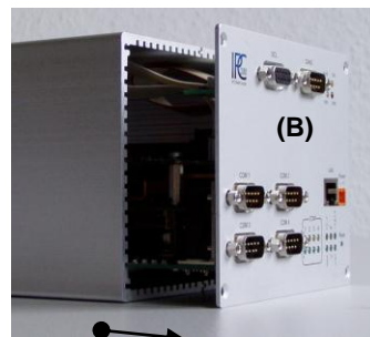
Abb. 2.5.2 Frontplatte (B) in Pfeilrichtung herausziehen.
