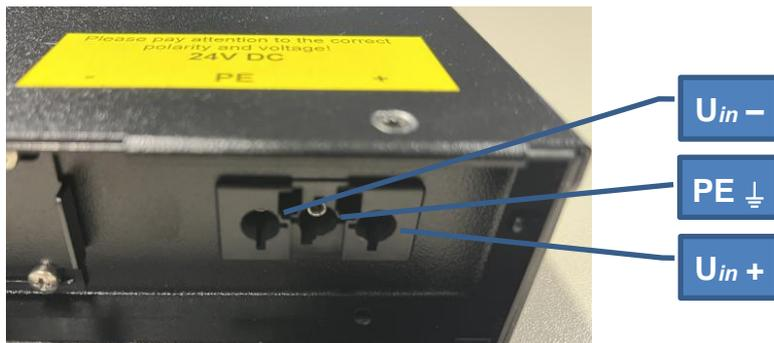
Abbildung 12: Gleichspannungsanschluss am Netzteil
