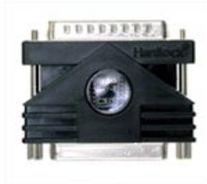
Abbildung 5: Hardlock-Dongle
