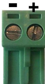
Abbildung 10: Stecker für den Anschluss der Stromversorgung
