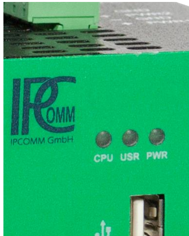
Abbildung 17: CPU, USB und PWR Anzeige
