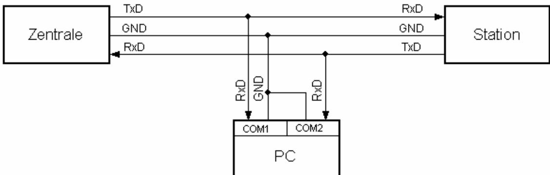
**PCM Anschlusschema Simulieren**
