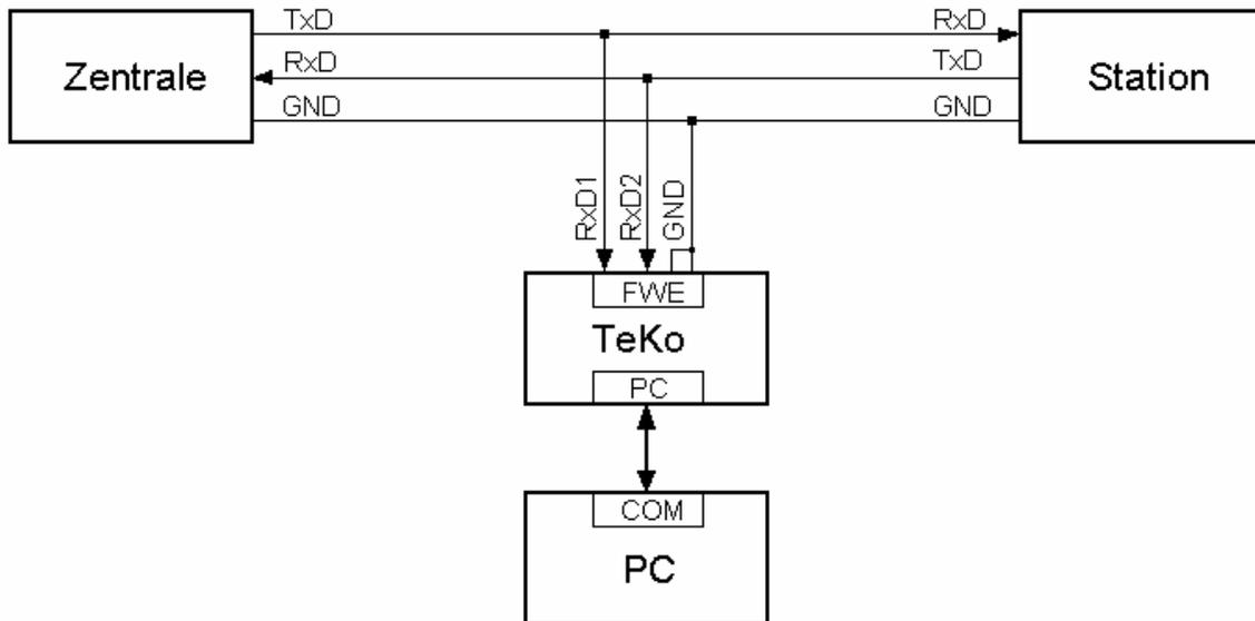
**Hinweis:** Der „FWE“ DSUB-Stecker auf dem TeKo hat keine Standardbelegung. Empfänger 1, Empfänger 2 und Sender, haben jeweils eine eigene Masse, Pinbelegung siehe Telegrammkonverter.
