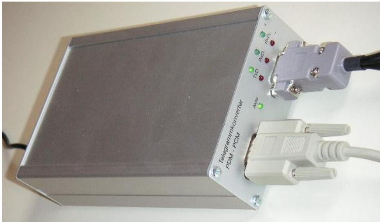
Das Prüfprogramm WinPP8 benötigt für SINAUT 8-FW DPDM Telegramme einen Telegrammkonverter. Der Telegrammkonverter (TeKo) konvertiert digitale Schrittdauermodulierte (PDM) Telegramme in pulscodemodulierte (PCM) Telegramme und umgekehrt. Bei der Konvertierung prüft er die Impulse und die Sperrzeit auf Richtigkeit. Die Sollwerte werden von WinPP8 vorgegeben.
