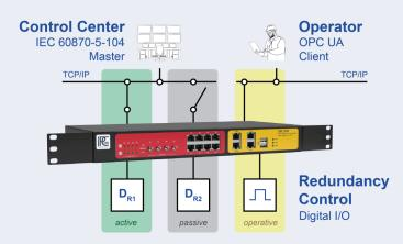
Um die Betriebs- und Ausfallsicherheit kritischer Anlagen zu gewährleisten, setzen Unternehmen redundante Systeme ein. Viele Geräte sind hierfür jedoch nicht geeignet. Mit Hilfe von *ipELB* können selbst solche Geräte zum redundanten Betrieb eingesetzt werden.
