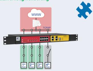
Soll der physikalische Verbindungszustand einzelner Netzwerk-Segmente überwacht und (fern)gesteuert werden, bietet sich der Einsatz von *ipELB* an.
